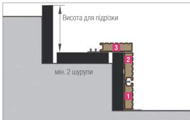
6. Фіксація кутика для кріплення з опорною конструкцією та повне загвинчування середньої скоби
