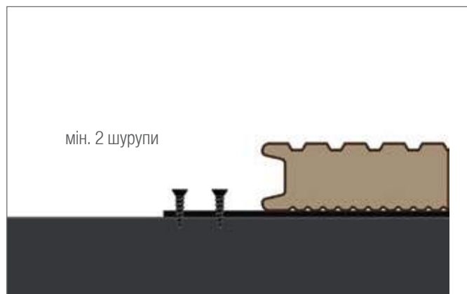
2. Фіксація пластини для кріплення з опорною конструкцією
